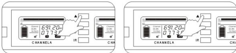
功率调节方法。按下IR键不放再按↑，当屏幕显示1或者2或者3的时候，再同时放开两个键，用↑调节功率，最后也是用红外对频实现改变手持话筒的功率。功率调节只在A边功能键调节，调好后，通过分别A边IR键和B边IR键来红外对频改变两支手持话筒的功率。
