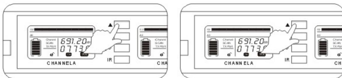
功率调节方法。按下 IR 键不放再按↑，当屏幕显示 1 或者 2 或者 3 的时候，再同时放开两个键，用↑调节功率，最后也是用红外对频实现改变手持话筒的功率。功率调节只在 A 边功能键调节，调好后，通过分别 A 边 IR 键和 B 边 IR 键来红外对频改变两支手持话筒的功率。
